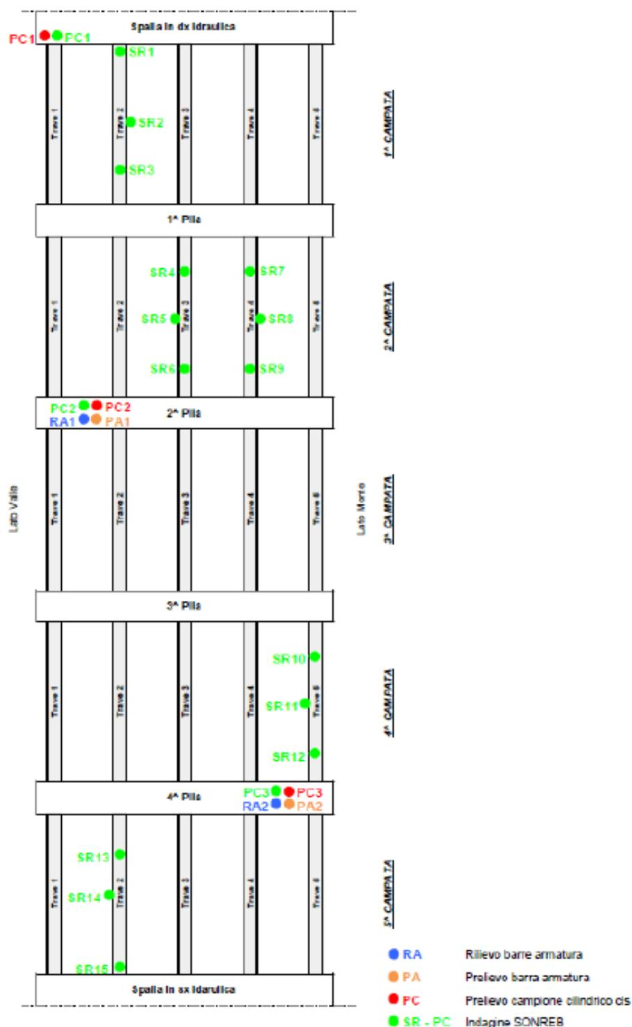
Dai rilievi delle barre di armatura effettuati nella 2° Pila in dx idraulica (RA1) e nella 4° Pila in sx idraulica (RA2) risulta che i ferri hanno diametri compresi tra  $\phi 12$  e  $\phi 14$  verticali,  $\phi 8$  e  $\phi 10$  orizzontali. Tali armature sono congruenti con quanto riportato negli elaborati grafici del progetto originario del ponte sul fiume Lamone, indicato dalla committenza come simile al ponte oggetto delle presenti verifiche.
